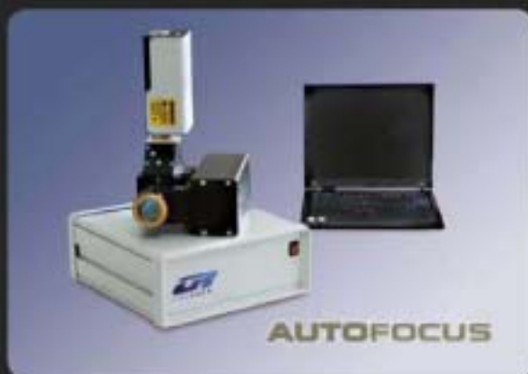
Système autofocus pour régulation automatique de la hauteur de focalisation jusqu'à 40 mm et avec une précision de 5µm
